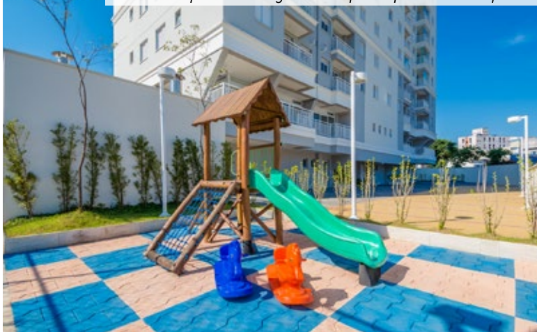
Sustentável: piso feito com grânulos de pneus que absorve o impacto
