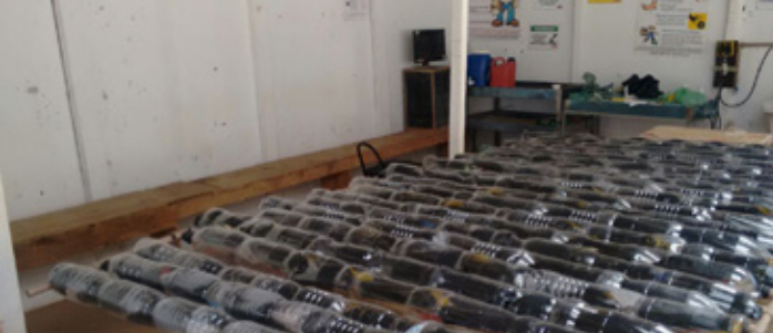
Mais uma inovação ambiental da MBigucci: Pannel solar feito com PET's e embalagens de leite, em teste no canteiro de obras do Mundi.
